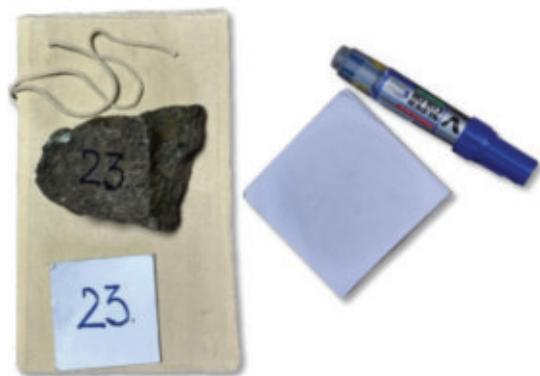
Slika 202. Platnena kesa (levo) na kojoj je obeležen uzorak i listić sa istim brojem; flomaster i blok listića (desno)
