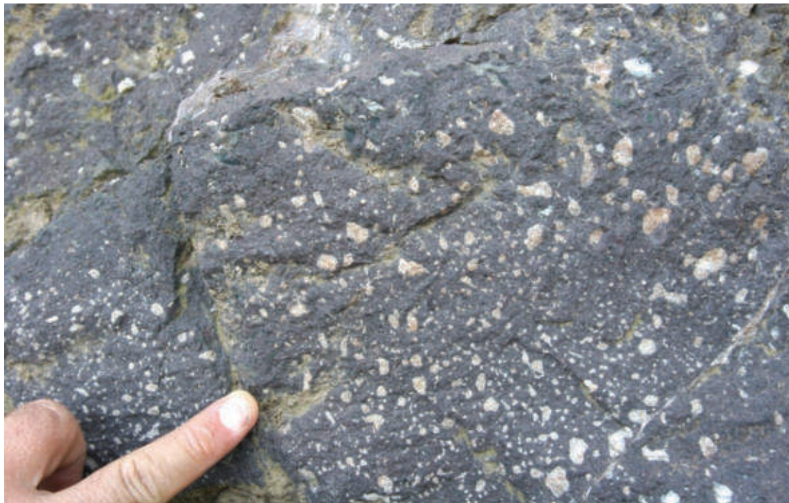
Slika 487. Mandole u spilitu (bele „tačke”), Đerdap, kod tunela 17
