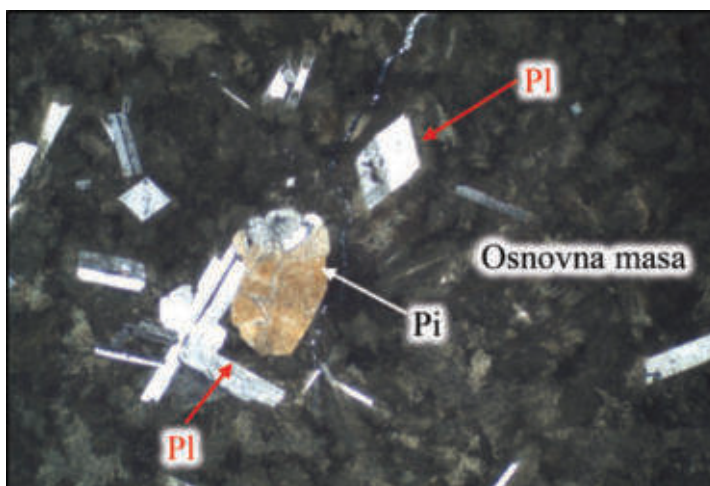
Slika 468. Mikrosnimak bazalta sa staklastom osnovnom masom, Pacifik; N+, 60x; Pl=plagioklas, Pi=piroksen
