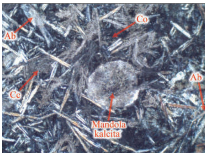
Slika 486 Spilit, Višegrad. Ab = albit, Cc = kalcit, Co = hlorit. N+, 60x.
