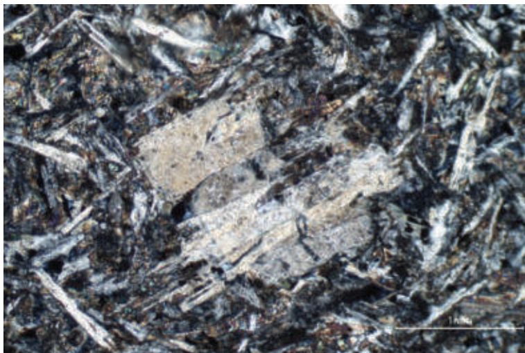
Slika 459. Mikrosnimak diabazporfiritita, Povlen: N+, 60x
