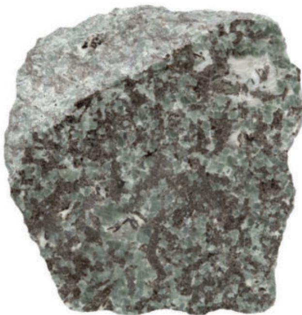
Slika 671. Ijolit, Kanada; uzorak veličine oko 15 cm: nefelin je sivo-zelen, piroksen crn
