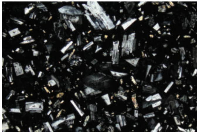
Slika 661. Vitrofirska struktura; N+, 50x
